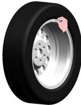
Снова проворачивайте колесо до тех пор, пока оно не встанет во второе положение. Смотрите на стрелки на правой стороне экрана. Когда они будут полностью окрашены, сделайте вторую метку на шине.
