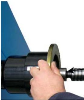
Установить вал на фланец, используя гаечный ключ.
