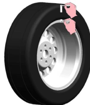
Снимите колесо с балансировочного стенда. Снимите шину и поверните её по отношению к ободу на 180°.
